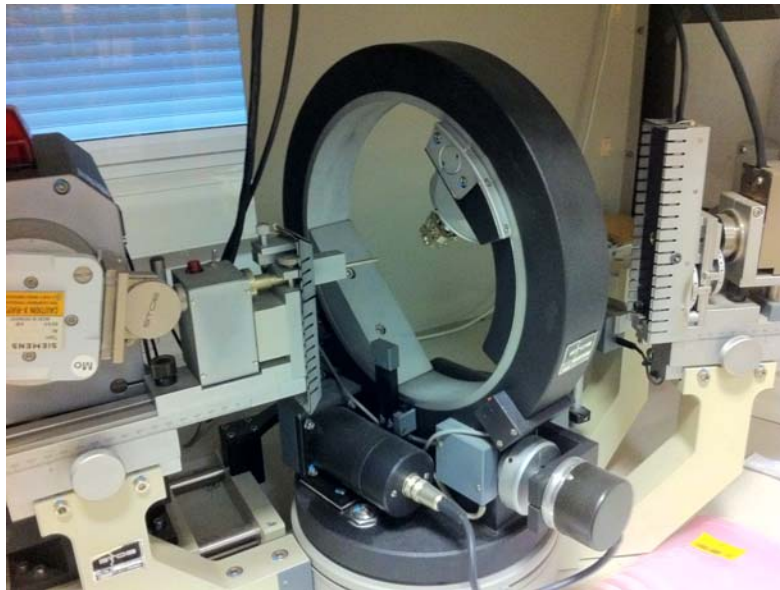
Difractómetro automático de cuatro círculos para monocristal KRISTALLOFLEX SIEMENS P4
