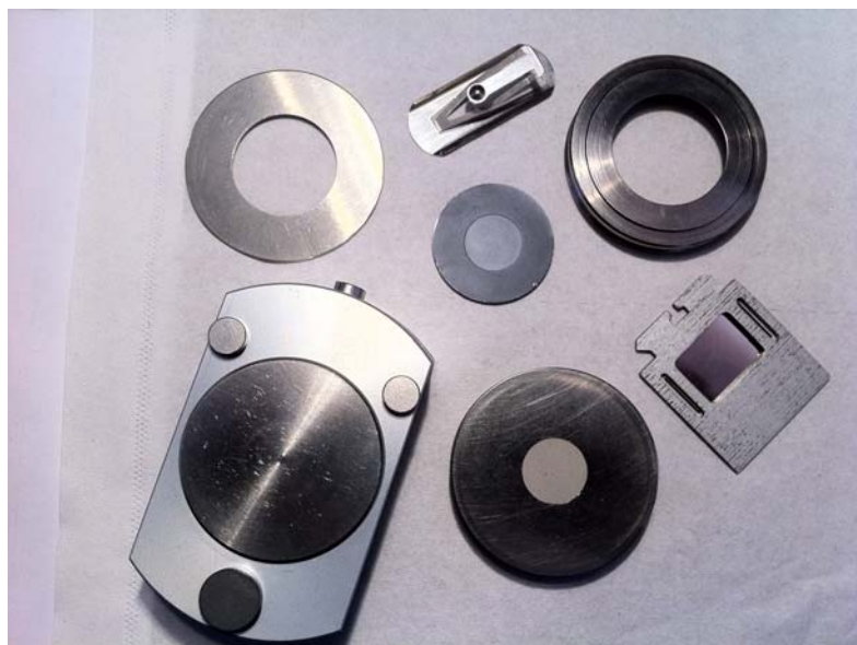
Utensilios para la preparación de muestras policristalinas para su análisis por difracción de rayos X por el método de polvo.
