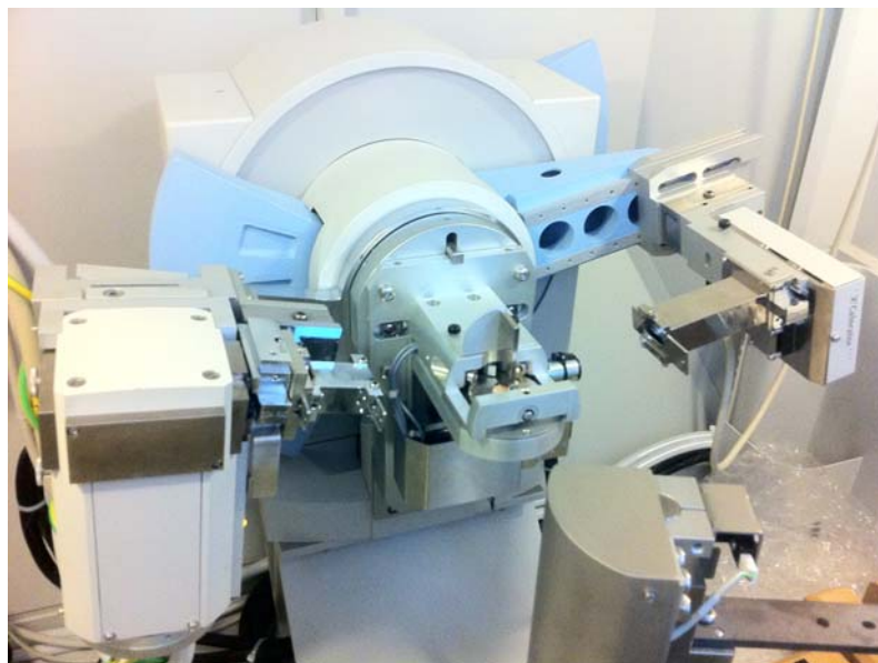
Difractómetro de polvo Philips XPertPro con intercambiador de muestras acoplado
